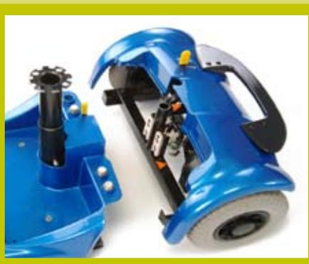
Desmontable en 2 partes muy manejables
